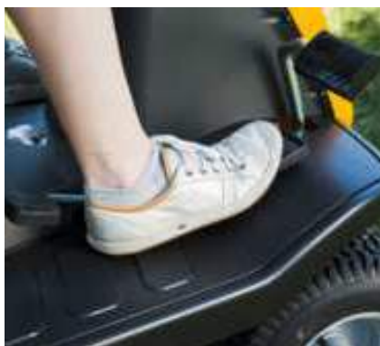
Hydrostatische transmissie Vlot en efficiënt de snelheid aanpassen met een gaspedaal. Geen versnellingsbak of knoppen, dus je handen kunnen comfortabel aan het stuur blijven.
