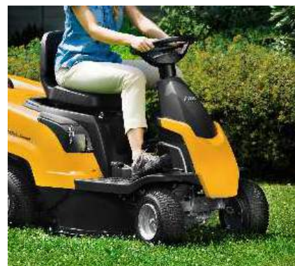
Korte draaicirkel Goed overzicht en een korte draaicirkel voor veilig en gemakkelijk manoeuvreren. Combi 1066 HQ: 1,55 m Combi 3072 H: 1,4 m
